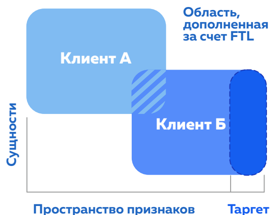
Рис. 5. Схема разделения данных при FTL
