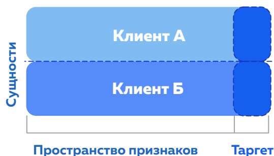
Рис. 1. Схема разделения данных при HFL
